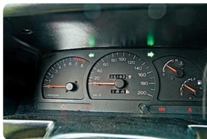
Панель приборов с механическим одометром. Базовые версии были без тахометра.
