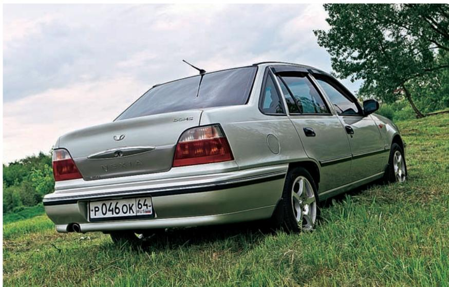
❖ И сегодня пропорции кузова «Нексии» весьма гармоничны. Антенна на крыше – итог борьбы с автоматически выдвигаемой штатной, которая часто закидала и теряла подвижность.
